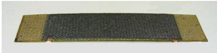
**Figure 6: Lipca Unimorph Actuator**
